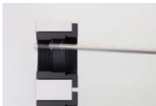
Měření oboustranným snímacím hrotem pro měření nahoře a dole
